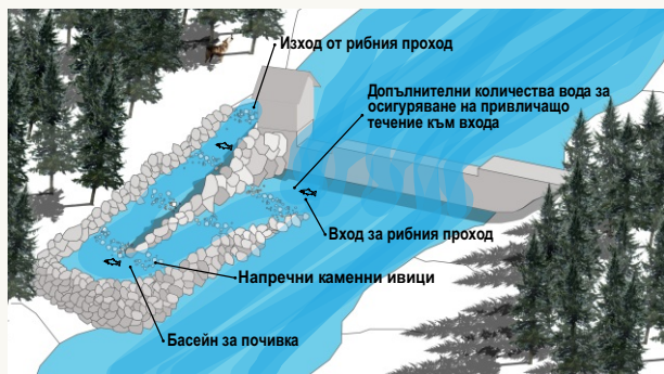
Схема на дънна рампа, заемаща само част от напречната структура. Сложна рампа, съставена от последователно оформени участъци (басейни) в резултат на подредба на камъни по дъното и изграждането на стени
