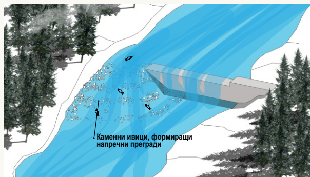
Схема на дънна рампа, заемаща само част от напречната структура, с по-полегата и по-стръмна част
