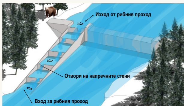
Басейнов тип рибен проход с горни отвори на напречните прегради
